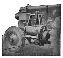
Automatische Seilführung. Auf die meisten Marken-Traktoren montierbar
