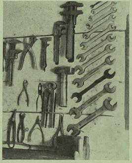
Abb. 23: Wir malen unter jeden Gegenstand sein Schattenbild. Die leeren Plätze (hier ein Schlüssel und eine kleine Zange) mahnen uns daran, das fehlende Werkzeug wieder an seinen Platz zu bringen.
