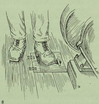
Abb. 21: Bei Transmissionsluken, die mehr als fussbreit sind, bringt man einen Deckel mit einfachem Handgriff an.
