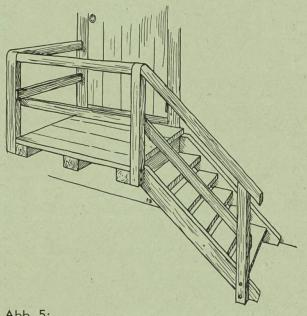
Abb. 5: Treppe mit Geländer und mittlerer Geländerlatte.
