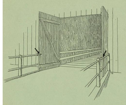
Abb. 36: So soll es sein: Freie Fahrt, keine Deichselausschläge, die Tore mit Torhaltern gegen Zuschlagen gesichert.
