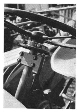
Mit dem «Lenkfix» kann das Steuerrad am Traktor festgestellt werden. Das ermöglicht es, den Traktorfahrer gelegentlich für die Mithilfe bei Arbeiten freizubekommen.
