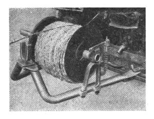
Für die Drahtrolle ist eine entsprechende Lagerung mit Ablaufbremse vorgesehen. Das Gerät kann an die Ackerschiene befestigt werden, Auch das Aufrollen von Draht übernimmt der Traktor. Die Drahtrolle wird dazu an den Traktor angeschlossen. Selbstverständlich können auch Drähte damit gespannt werden.
