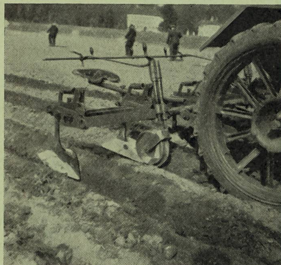
Abb. 32b: Häufelkörper geeignet als Vor-scharen für Pflanzenlochapparate sowie zum Zudecken u. Hochhäufeln.
