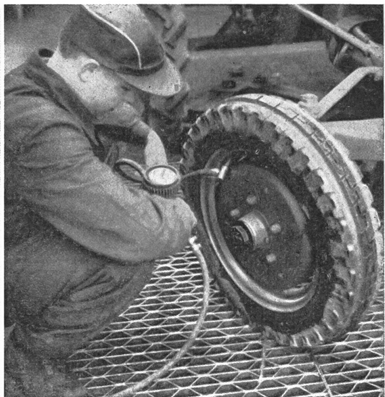
Kompressor und Handluftprüfer sorgen für schnelles Aufpumpen und Einhalten des vorgeschriebenen Reifendrucks
