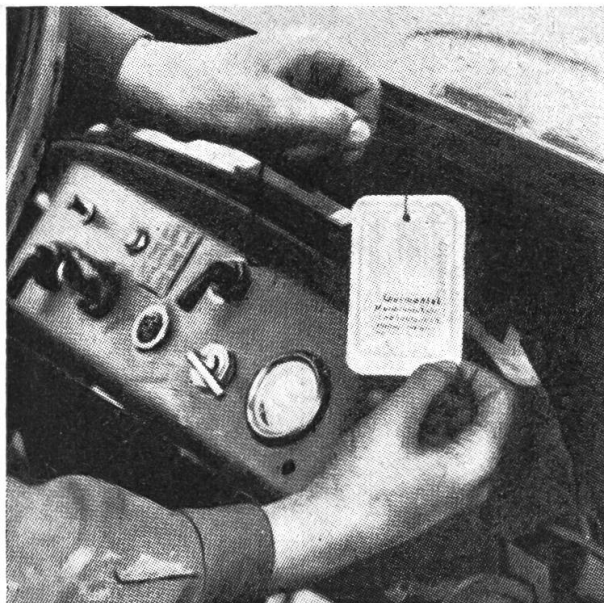
Der Ölwechselanhänger als Gedächtnisstütze für den Schlepperfahrer
