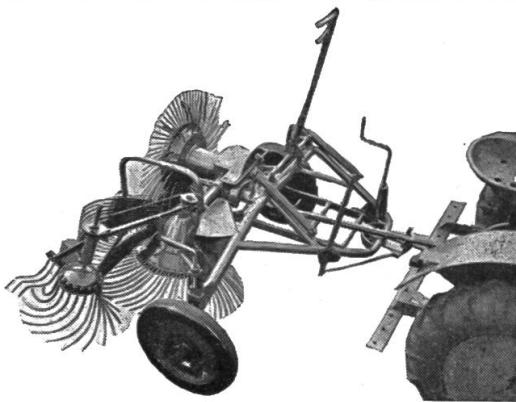
Der bewährte **Rekord Vorratsgraber-Vollerntemaschine** für Zapfwelle als Anhängemaschine an jeden Traktor, ebenso für Hydraulik und Gespannzug. Stahlgetriebe und Kugellager im Vollölbad, Zusatzsiebglocke mit klarer Reihenablegung, saubere Freilegung ohne Zudeckverluste, hohe Leistung bei schonender Behandlung des Erntegutes. Eignet sich sehr gut zur Zuckerrübenernte. Für schweizerische Verhältnisse geschaffen, sehr solid, preislich vorteilhaft.
