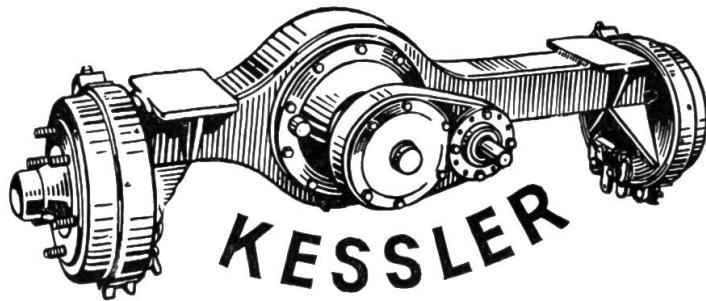
KESSLER - Triebachse mit Differential, Freilauf und Freilaufsperrre, zum Vor- und Rückwärtsantreiben. Ganzes Getriebe im Oelbad. Genaues Anpassen an jeden Traktor und Einachstraktor.
