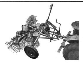
Der bewährte **Rekord Vorratsgraber-Vollerntemaschine** für Zapfwelle als Anhängemaschine an jeden Traktor, ebenso für Hydraulik und Gespannzug. Stahlgetriebe und Kugellager im Vollölbad, Zusatzsiebglocke mit klarer Reihenablegung, saubere Freilegung ohne Zudeckverluste, hohe Leistung bei schonender Behandlung des Erntegutes. Eignet sich sehr gut zur Zuckerrübenernte. Für schweizerische Verhältnisse geschaffen, sehr solid, preislich vorteilhaft. **LOUIS HILTI, SCHAAN FL** Tel. (075) 2 17 78
