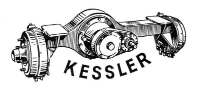
KESSLER - Triebachse mit Differential, Freilauf und Freilaufsperre, zum Vorund Rückwärtsantreiben. Ganzes Getriebe im Oelbad. Genaues Anpassen an jeden Traktor und Einachstraktor.
