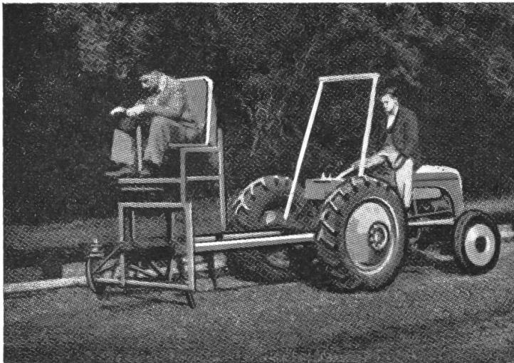
Versuchschassis für die Untersuchung der relativen Lage des Traktorfahrersitzes und der Arbeitswerkzeuge.
