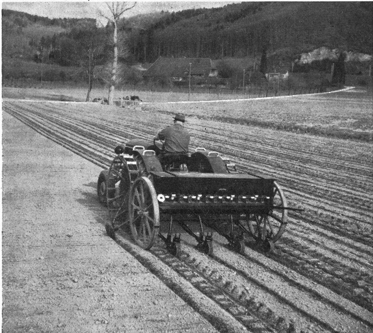
Die AEBI-Sämaschine lässt sich am modernen Vielzwecktraktor an die Dreipunkt-Hydraulik anbauen. Zum Säen arbeitet sie in der üblichen Weise mit Bodenantrieb; beim Wenden und beim Fahren auf der Straße hebt man sie mit der Hydraulik vom Boden ab. Die Sämaschine ist mit Spurmarkierern und mit Spurlockerern für den Traktor ausgerüstet. Die Ausrüstung passt auch an früher gelieferte AEBI-Sämaschinen.
