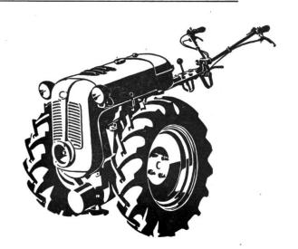
Einachser RAPID, Typ S-SPECIAL mit 2 Zyl. MAG-Motor
