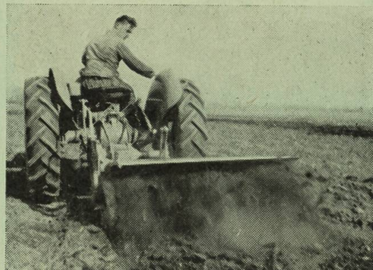
Abb. 23a und b: Zapfwellengetriebene Motoreggen. Die Breite des Rotavators nach Abb. 23b reicht nicht über beide Radspuren hinaus (Anpassung an Motorleistung). Das bedingt, dass man mit der Bearbeitung in der Mitte des Feldes beginnt und ringsherum fährt.
