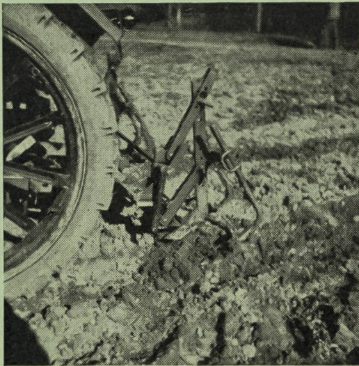
Abb. 3a: Dreiteiliger Spurlockerer, behelfsmässig an der Ackerschiene befestigt.
