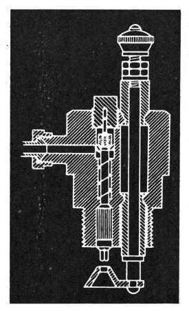
Abb. 1: Diese von Beard entwickelte Konstruktion (Vergaser mit Einspritzpumpe aus der Zeit um 1905) beruhte darauf, dass ein vom Motor angetriebener Exzenternocken auf einen federbelasteteten Pumpenkolben wirkte. Das Benzin wurde über ein Rückschlagventil angesaugt, zu Beginn des Motorsaughubes gegen den Federdruck des kegelförmigen Düsenventils in den Mischraum der Saugleitung gespritzt und dabei zerstäubt.
