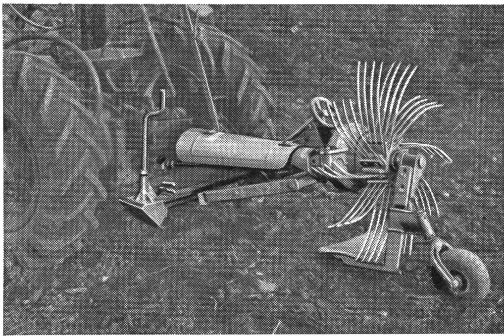
**Zapfwellen-Kartoffelgraber** Kombinierbar mit Rübenheber seitlich und in der Höhe vom Sitz aus verstellbar, Rutschkupplung, Antrieb im Oelbad, auf Kugellager laufend. Für Traktoren mit und ohne Hydraulik.
