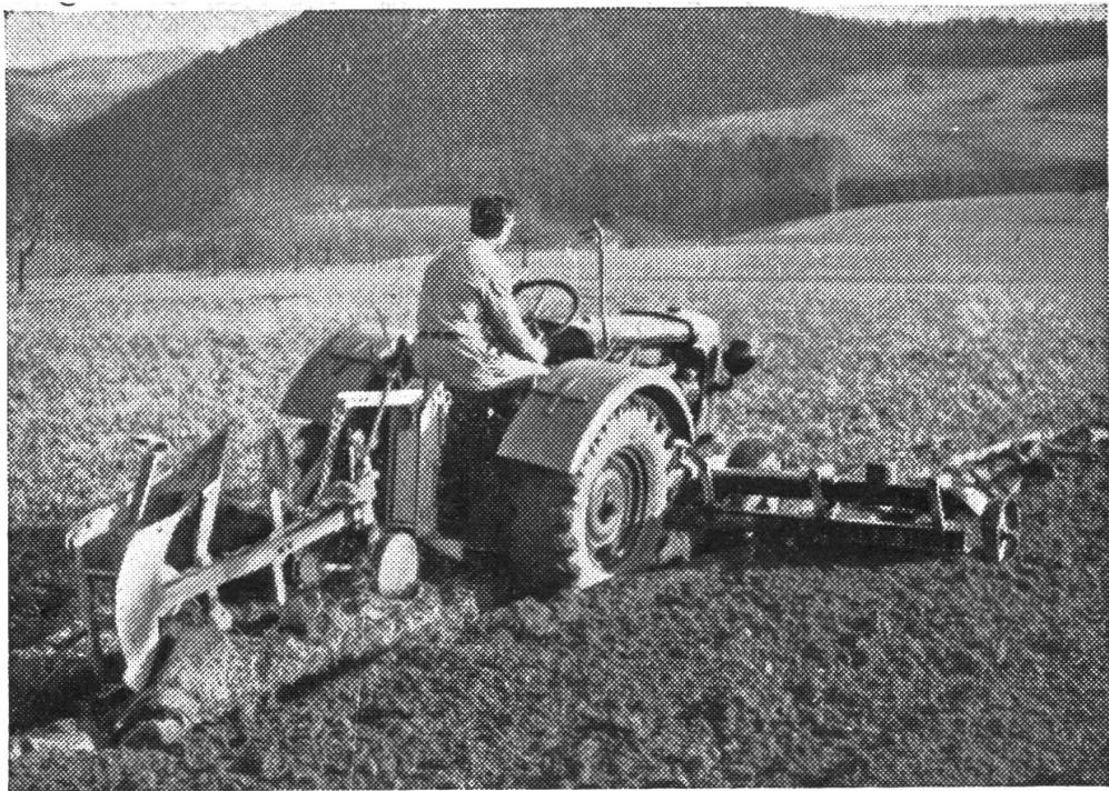
**Ott-Anbaupflüge** mit Stützrädern leisten in der Ebene und am Hang beste Arbeit. Sie sind während der Arbeit weitgehend unabhängig von den Bewegungen des Traktors und in der Arbeitsleistung deshalb den Selbstthalterpflügen am ähnlichsten. Verlangen Sie unverbindliche Offeren für Anbaupflüge und Anbaukultivatoren.
