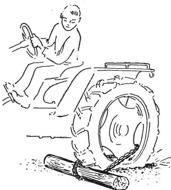
der Pflock nicht zu kurz angebunden werden. Hat ein Traktor keine durchlochten Felgen, so ist es zweckmässig, an beiden Seiten der Folge Bügel anschweissen zu lassen. E. A. in O.
