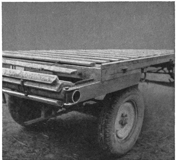
Haspelende. Wir sehen hier vor allem die einfache Lagerung. Es braucht nur der Schraubenbolzen, desgleichen der zweite Bolzen am linken Ende, entfernt zu werden, und schon kann der ganze aufgewickelte Lattenrost abgenommen werden.
