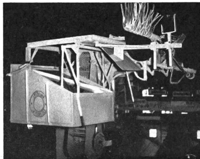
Abb. 5 Kartoffelvollernter «DeWulf» mit seitlich angebauter Verlese-einrichtung und Vortsortierung.
