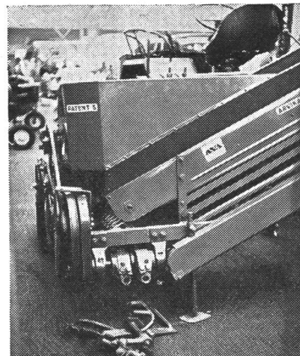
Abb. 8: Rübensvollernter «AVA». Wird vom Traktor getragen und angetrieben. Hier Köpfer, dahinter Krautförderer, der die Köpfe sofort auf das Förderband schiebt.
