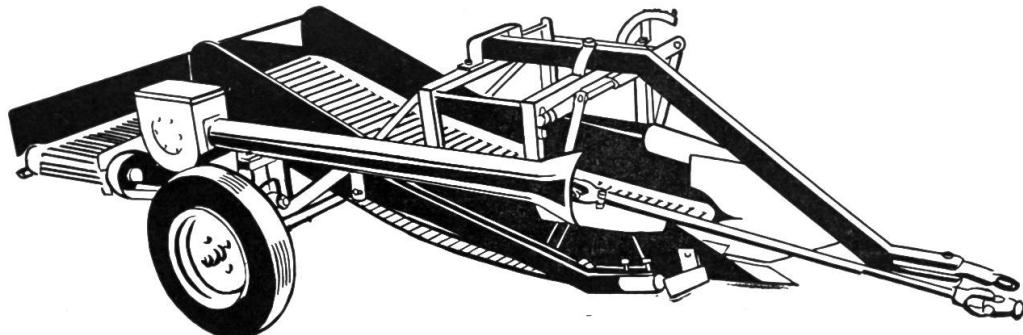
**für Zapfwellenantrieb.** Verstellbare Radspur, leicht und handlich. Ueber eine zweiteilige Rodeschar gelangt die Furche auf ein Siebband, welches durch Exzenter in Rüttelbewegung versetzt, die Kartoffeln auf eine äusserst schonende Art von Erde befreit. Durch ein Quer-Transportband erfolgt die Reihenablage nach rechts seitwärts. Gegen einen bescheidenen Mehrpreis wird ein Rübenrodegerät mitgeliefert.
