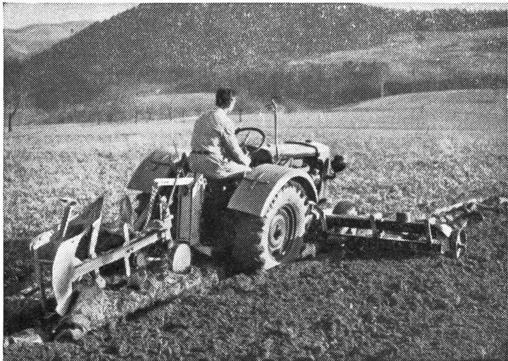
**Ott-Anbaupflüge** mit Stützrädern leisten in der Ebene und am Hang beste Arbeit. Sie sind während der Arbeit weitgehend unabhängig von den Bewegungen des Traktors und in der Arbeitsleistung deshalb den Selbstthalterpflügen am ähnlichsten. Verlangen Sie unverbindliche Offerten für Anbaupflüge und Anbaukultivatoren.
