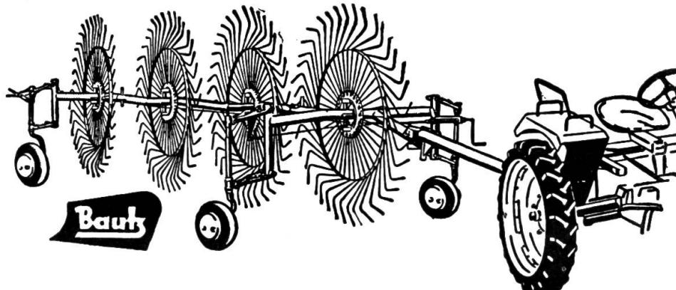
bei äusserster Schonung des Erntegutes sowie der Grasnarbe dank der neuartigen elastischen Federzinken.
