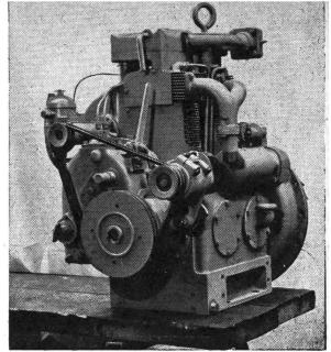
Abb. 3: Der Wisconsin-Vierzylinder V-Motor, luftgekühlt. Links der von der Lichtmaschine angetriebene Verteiler.
