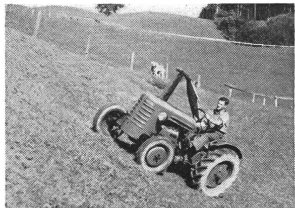
Abb. 9: Die hydraulisch betätigte Dreipunktaufhängung nach DIN 9674 mit Ackerschleife. Abb. 10: Das kleinere Alpina-Oekonom-Modell ist geländegängig und eignet sich gut für bergige Lagen.
