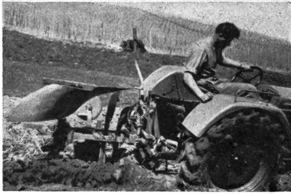
Abb. 11: Die hohe Ausführung des Alpina-Oekonom mit Hatz-Dieselmotor, Knecht-Einmannpflug an der Dreipunktaufhängung.
