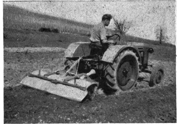
Abb. 11: Die hohe Ausführung des Alpina-Oekonom mit Hatz-Dieselmotor, Knecht-Einmannpflug an der Dreipunktaufhängung.
