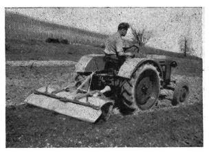
Abb. 11: Die hohe Ausführung des Alpina-Oekonom mit Hatz-Dieselmotor. Knecht-Einmannpflug an der Dreipunktaufhängung.
