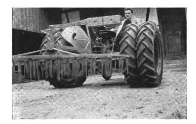
Zur Verminderung des Bodendruckes bei der Saatbettherstellung mit dem Traktor benütze ich mit Vorteil und Erfolg anstelle der Gitterräder Doppelpneus. Die Anschaffungskosten für eine Garnitur neue Felgen, Pneus, Schläuche und Befestigungsschrauben kommen auf ca. Fr. 200.— höher zu stehen als Gitterräder. Es können aber auch abgefahrene Pneus verwendet werden. Ich habe auch dazu passende Spurlockerer angeschafft, die sich gut bewähren. Vorteile der Doppelpneus:
