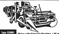
Schnittbreite, 1/3 - 1/2 ha Stundenleistung, 34 PS Dieselmotor, die Sensation im Mähdrescherbau.
