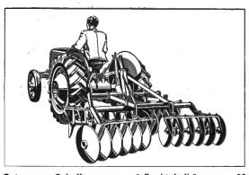
Getragene Scheibenegge, 3-Punkt-Aufhängung. 20 oder 24 Scheiben, 45 cm Durchmesser. Arbeitsbreiten 180–210 cm. Äusserst solide, leistungsfählge Konstruktion.
