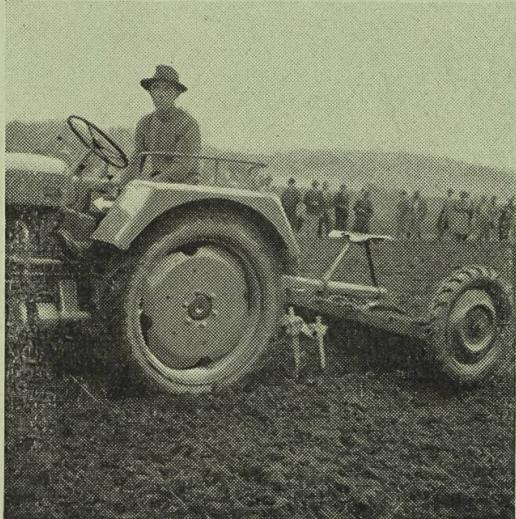
Zur Bearbeitung leichter bis mittelschwerer Böden genügt die Anwendung eines Kultivators zum Niederbrechen und einer Egge zur Oberflächenbearbeitung. Das Kultivieren erfordert erfahrungsgemäss grosse Zugkräfte. Zur Verbesserung des Adhäsionsvermögens und zur Verminderung des Rollwiderstandes empfiehlt sich daher das Anbringen von Gitterrädern.
