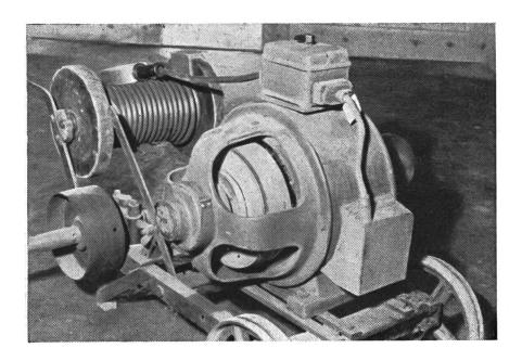
tromotoren soll genügend wärmebeständig sein. Es muss neben den Eigenschaften eines Kugellagerfettes (säurefrei, alterungsfest, etc.) einen Tropfpunkt von mindestens 100 Grad C aufweisen.
