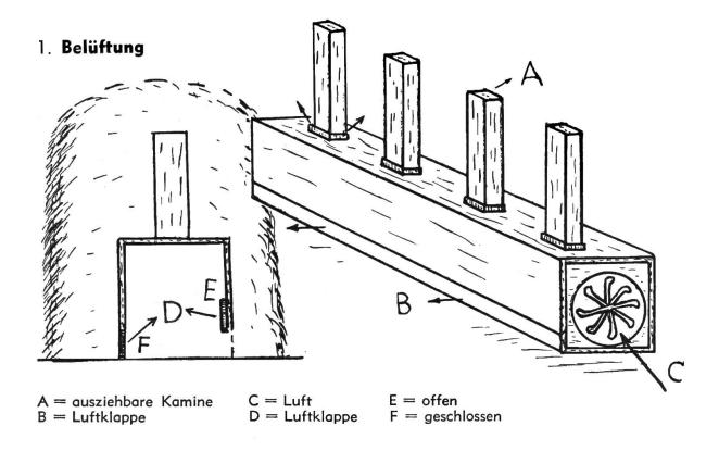
und wird dort durch einen mechanisch erzeugten Luftstrom auf ca. 18-20 % Feuchtigkeit nachgetrocknet.
