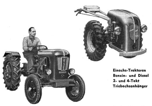
4-Rad-Vielzweck-Traktor TK 15 mit Diesel- oder Benzin-Motor mit 4- oder 8-Gang-Getriebe Triebachsanhänger
