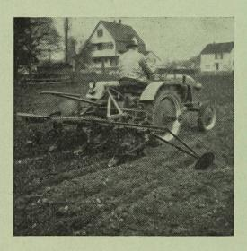
Abb. 2: Pflanzlochen mit einem Aufbau-Vielfachgerät
