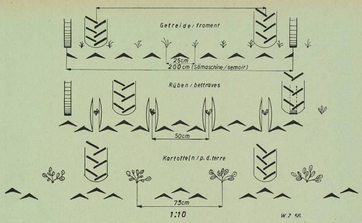
Abb. 3: Traktorspurweite 150 cm
