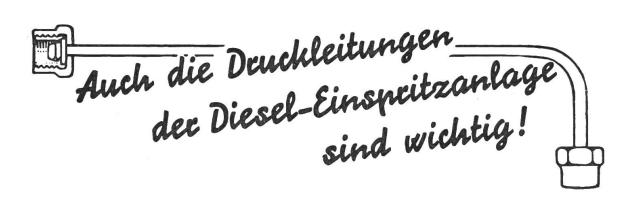
Länge, lichte Weite und Wandstärke der Druckrohrleitungen zwischen der Einspritzpumpe und den Düsen beeinflussen das Einspritzgesetz einer Anlage. Sie sind durch Konstruktion und Arbeitsweise des Motors und der Einspritz-Ausrüstung festgelegt. Wird ihr Einfluss als unwichtig angesehen oder nicht beachtet, z. B. beim Ersatz unbrauchbar gewordener Leitungen, dann muss mit Störungen im Betrieb gerechnet werden.
