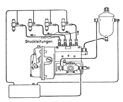
Die Kraftstoff-Leitungen einer Einspritzanlage für einen Fahrzeug-Dieselmotor zu Russbildung, Undichtwerden usw. neigen als rauhe grobporige Rohre. Vor allem aber splittert beim Anstauchen der Anschluss-Dichtkegel sowie beim Biegen verzunderter Rohre, aber auch wenn die Leitungen eingebaut sind, immer wieder Zunder ab.
