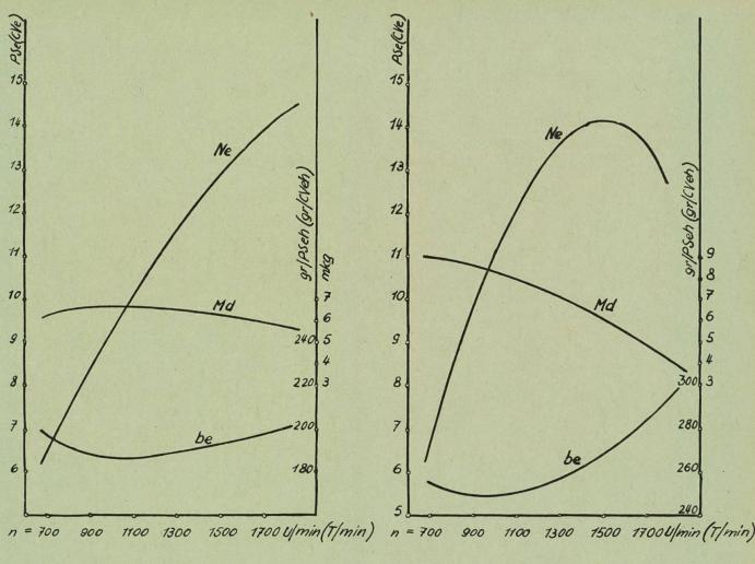
Abb. 2: Leistungsdiagramm eines sehr guten Motors.
