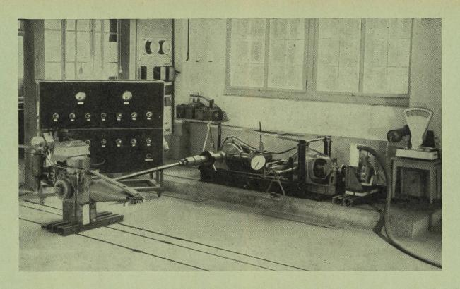
Abb. 1: Der elektrische Bremsstand (Pendel-Dynamo) des IMA an der Kant. landw. Schule Strickhof / Zürich.
