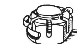
Ein Splint darf wegen Bruchgefahr nicht mehrmals verwendet werden. Stets neue Splinte einsetzen !!
