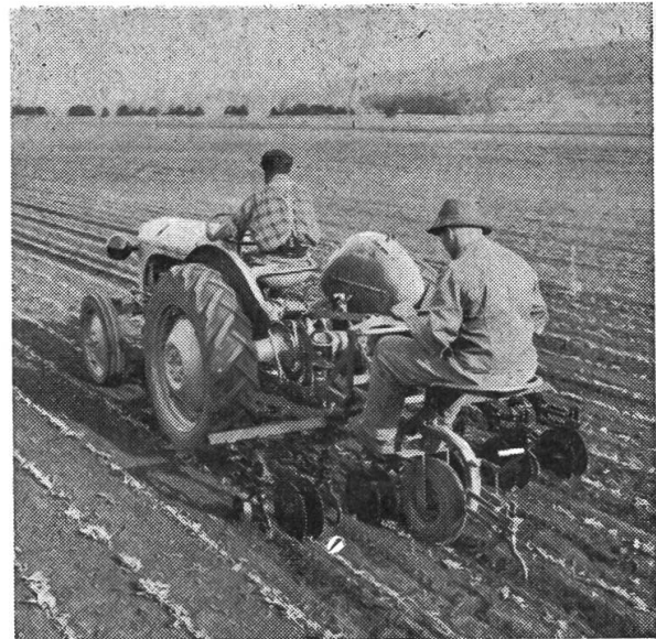
Und hier das Gerät mit der ersten Sitzsteuerung mit der steuerbaren Stützrolle unter dem Gerätesitz.
