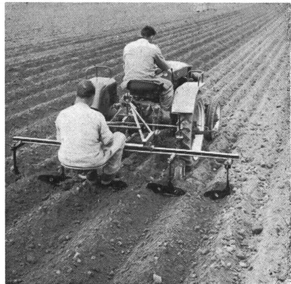
Zudecken der Kartoffeln mit den Zudeck- und Häufelscharen.
