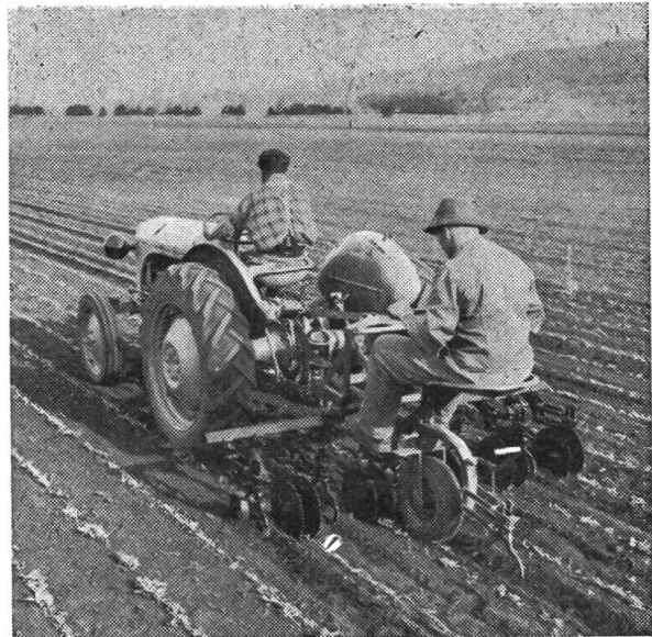
Und hier das Gerät mit der ersten Sitzsteuerung mit der steuerbaren Stützrolle unter dem Gerätesitz.
