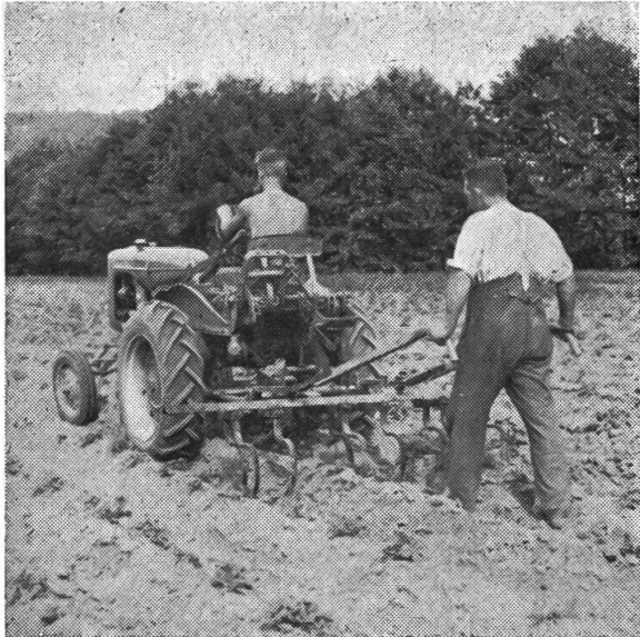
Das erste Bucher-Traktor-Vielfachgerät mit Holmensteuerung am «Allis Chalmers»-Hacktraktor.
