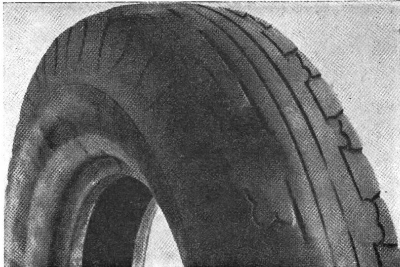
Abnutzung eines Pneus durch mechanische Mängel, wie abgenützte oder lose sitzende Kugellager, Abgenützte Achsschenkelbolzenlager, verbogene Achsen oder Spurstangen, falscher Radstellungen (Sturz, Vorspur).
