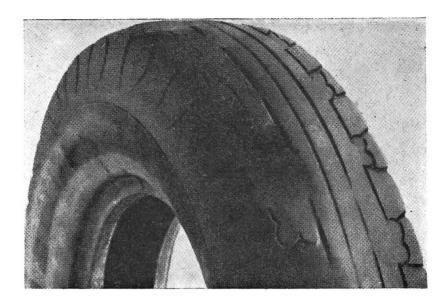
Abnützung eines Pneus durch mechanische Mängel, wie abgenützte oder lose sitzende Kugellager, Abgenützte Achsschenkelbolzenlager, verbogene Achsen oder Spurstangen, falscher Radstellungen (Sturz, Vorspur).
