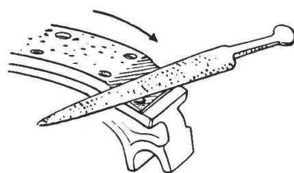
Ungleichmässig abgenützte **Brems-trommeln** müssen in einer Spezial-werkstätte zentrisch ausgedreht wer-den.
