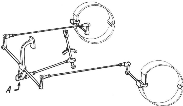
Schema einer Traktor-Bremsanlage. Die Handbremse ist feststellbar. Bei Betätigung des Fussbremspedals wird der Handbremshebel infolge der Schlitzführung bei A nicht mitgenommen.
