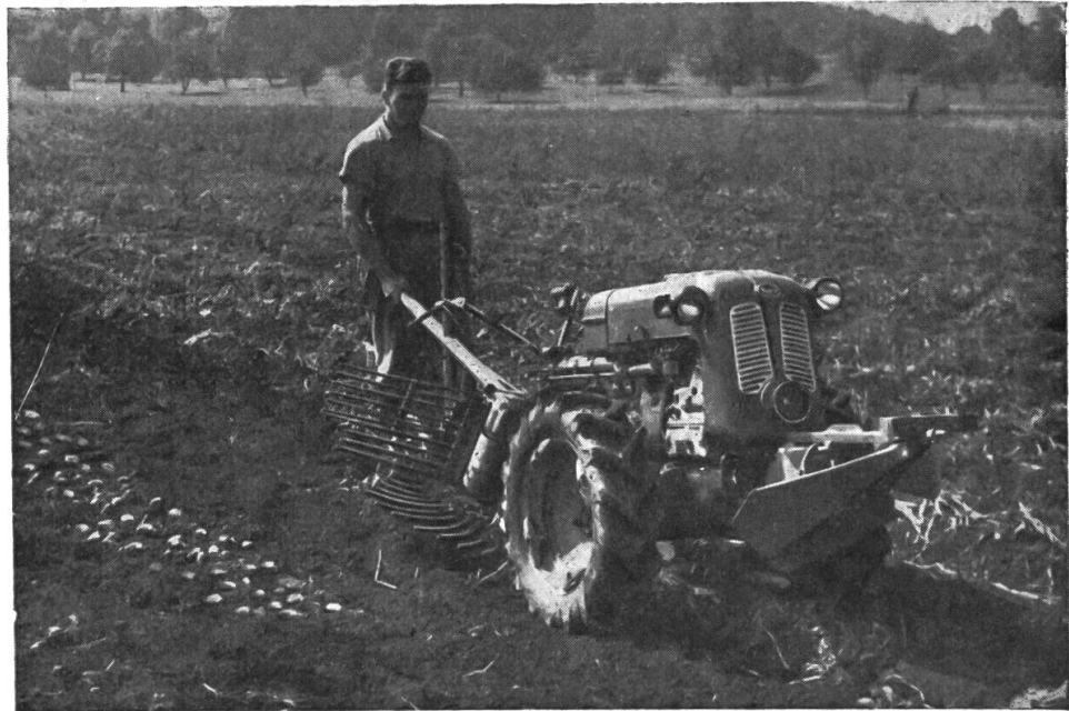
Abb. 4 Rapid-Einachs- traktor mit hochgeklapptem Mittelschwinger und Vorrats- Kartoffelroder
