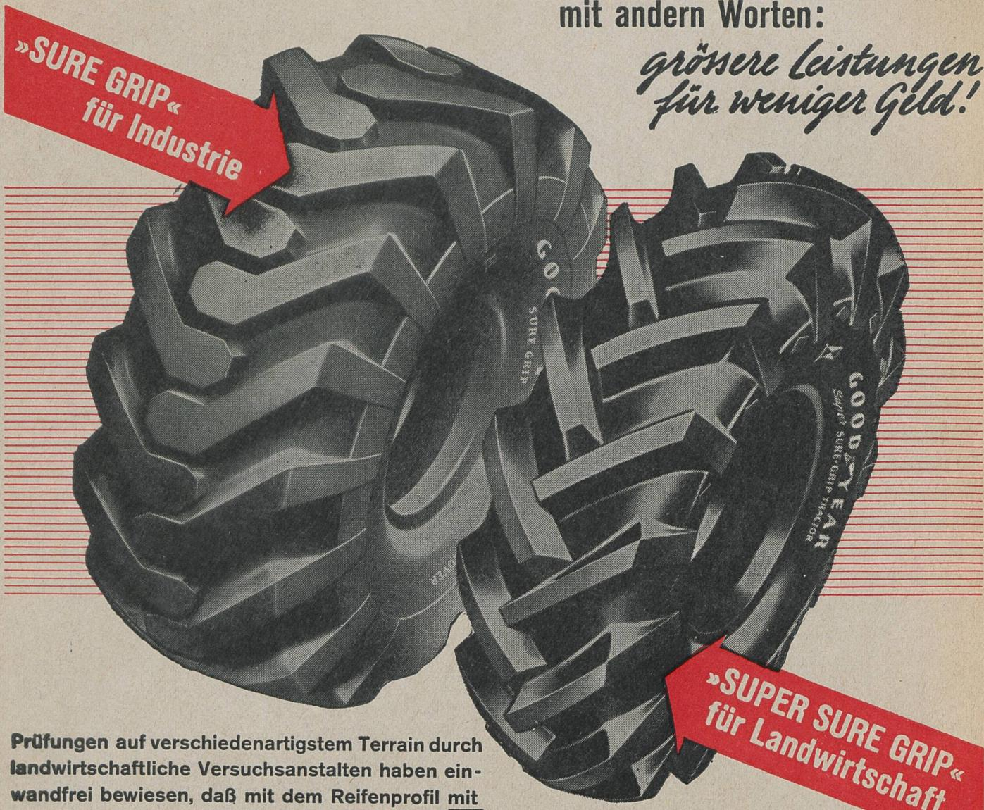
Prüfungen auf verschiedenartigstem Terrain durch landwirtschaftliche Versuchsanstalten haben einwandfrei bewiesen, daß mit dem Reifenprofil mit geraden, konisch angeordneten Querstollen, die in der Mitte unterbrochen sind, bei weitem die größte Zugkraft erreicht wird,
