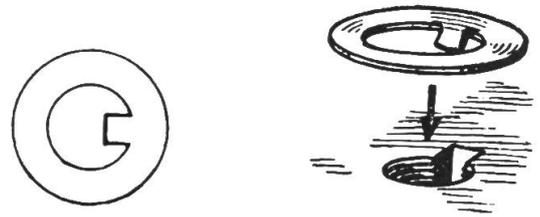
Das Sicherungsblech wird mit dem Meißel aufgebogen und durch Hammer-schläge in der Endlage fixiert.
