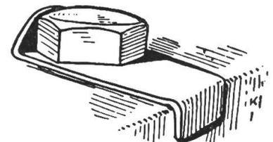
Sicherung für eine am Rande liegende Schraube (Mutter)
