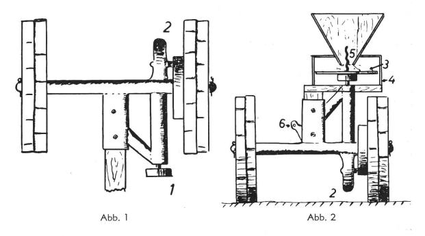
An der Mähmaschine werden alle überflüssigen Teile abmontiert, so dass nur die Räder mit dem Fahrgestell und das Getriebe mit dem Kurbelrad übrig bleiben (siehe hierzu Abbildung 1). Das nach vorne zeigende Deichselende wird eingekürzt und um 90 Grad angehoben, so dass es nach oben steht. Dadurch kommt auch das Kurbelrad (1) nach oben und in waagrechte Lage. Das Getriebe (2) hingegen schaut nach unten. Dieses darf jedoch nicht
