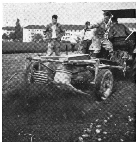
Abb. 4: Zapfwellengetriebener Siebrad-Vorratsgraber Kromag.
