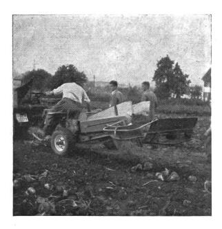
Abb. 10: Zapfwellengraber Lanz mit verstellbarem Seitenableger.
