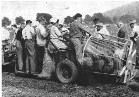
Abb. 5: Zapfwellengraber Kuxmann mit Doppelsiebrad.
