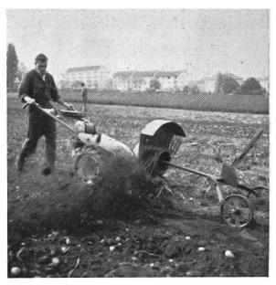
Abb. 2: Schleudervorratsgraber Bucher mit gleichnamigem Einachstraktor.
