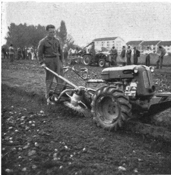
Abb. 3: Siebrad-Vorratsgraber Rapid mit gleichnamigem Einachstraktor.
