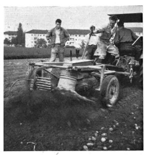
Abb. 4: Zapfwellengetriebener Siebrad-Vorratsgraber Kromag.
