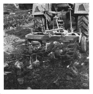
Abb. 9: Traktor mit zweireihigem zapfwellengetriebenem Schüttelrost Bur.
