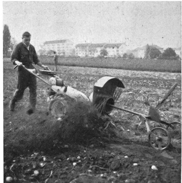
Abb. 2: Schleudervorratsgraber Bucher mit gleichnamigem Einachstraktor.
