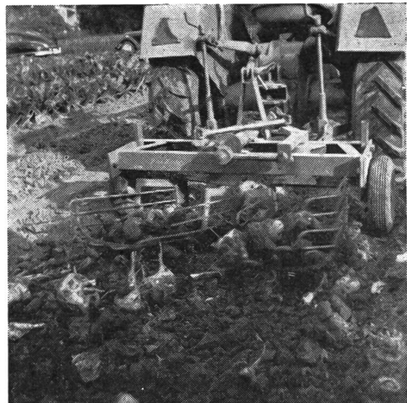
Abb. 9: Traktor mit zweireihigem zapfwellen- getriebenem Schüttelrost Bur.
