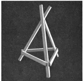
Abb.11: Zur Kennzeichnung der am Strassenrand aufgestellten Wagen oder Gegenstände eignet sich auch ein auf einem selbstangefertigten Dreifuss aus Leisten (s. Abb 12) aufgestelltes Brett mit rotweissem Anstrich (weisse Farbe = Bestell-Nr.11; rote Farbe = Bestell-Nr. 12).
