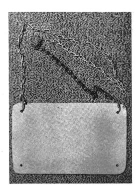
Abb.17: Detail einer Befestigungsvorrichtung, die das Auswechseln der dreieckigen Rückstrahler an Maschinen gestattet, deren Einsatz zu verschiedenen Zeiten erfolgt (z.B. Sämaschine und Bindemäher). Links die Schlaufe, an der der Haken (rechts) eingehängt werden kann (es handelt sich um Flacheisen). Die Sicherung kann mittels einer auf der Höhe der Pfeile durch ein Loch gezogenen Schnur erfolgen.
