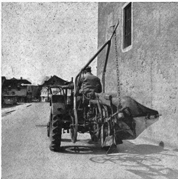
Abb.15: Beispiel eines zweckmässig markierten Traktors mit Pflug. Der Rückstrahler ist mittels Haken befestigt. Man beachte zudem, wie der Traktorfürer mit einem rot-weiss gestrichenen Stab seine Absicht zum Abzweigen bekannt gibt.
