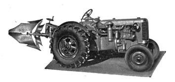
einer der besten und vielseitigsten Traktoren der Welt. — Der «ZETOR»-Diesel-Traktor erringt gegen stärkste Weltkonkurrenz die argentinische Goldmedaille. Mit seinem robusten 2-Zylinder 4-Takt-Dieselmotor von 26 PS, seinem unverwüstlichem, starkem 8-Ganggetriebe, mit modernster, einzigartiger Differentialsperre und seiner ausserordentlich leistungsfähigen hydr. Hebevorrichtung mit normalisierter Dreipunktaufhängung, gehört der «ZETOR»-Traktor seit Jahren zu den führenden Traktormarken der Welt.
