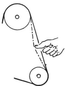
Riemenspannen durch Ausschwenken der Lichtmaschine am Traktor
