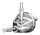
Das Gehäuse kann nach lösen einer Schraube in 2 Teile zerlegt werden.
