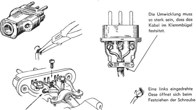
Das Drahtende wird nach rechts zusammengebogen, damit es beim Festziehen der Schraube mit eingebogen wird.
