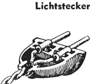
A) Beide Enden werden gleich lang abisoliert, die Drahtlitzen zusammenge-
