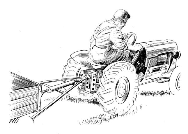
Abb. 1: Sichere Fahrt mit dem beschriebenen Aggregat Tetrax 303 zur hydromechanischen Betätigung irgend einer Anhängerbremse. Der Anhänger wird vom Führersitz aus mühelos und zuverlässig gebremst.
