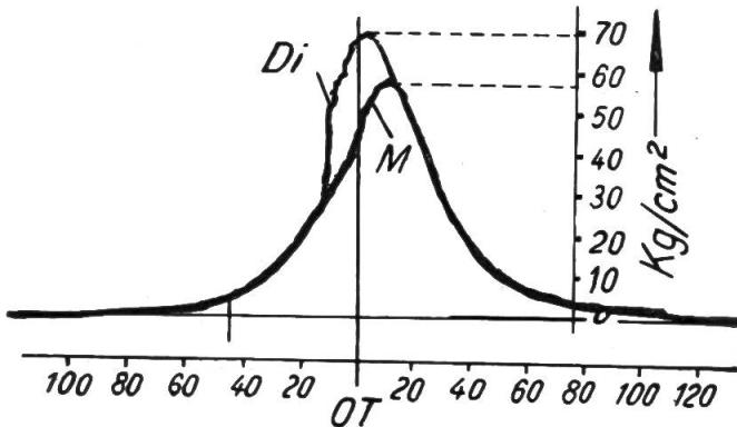
**Indikatordiagramm eines M-Motors und eines Dieselmotors mit direkter Einspritzung.**
