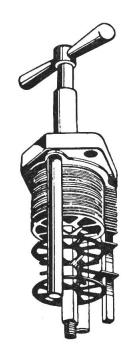
Aufbau eines Spaltfilters für Motorenöl.
