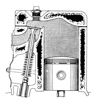
Stark verkalkte Wasserkammer eines Motors.
