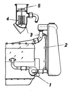
Wasserkreislauf bei kaltem Motor und Verwendung eines Thermostates.
