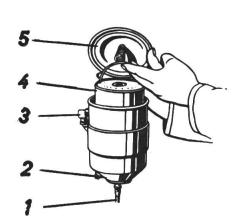
Ausbau des unzerlegbaren Feinfilterelementes
