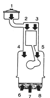
Schema über die Verunreinigungen im Motorenöl.
