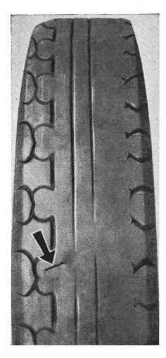
Durchgehender Schnitt durch Lauffläche und Karkasse
