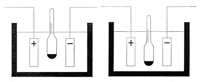
Abb. 1: Batterie geladen, hohe Säuredichte Abb. 2: Batterie entladen, niedrige Säuredichte
