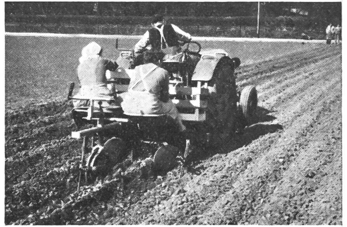
Abb. 15 Bucher-Sämaschine an der Dreipunktaufhängung des «Meili». Rechts von der Sämaschine das Markiergerät, in dessen Furche das rechte Trakturvorderrad zurückfahren muss.
