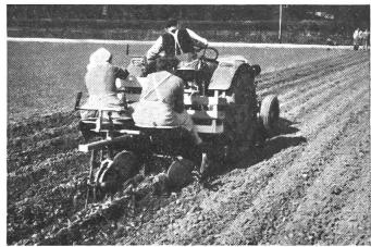
Abb. 15 Bucher-Sämaschine an der Dreipunktaufhängung des «Meili». Rechts von der Sämaschine das Markiergerät, in dessen Furche das rechte Traktorvorderrad zurückfahren muss.
