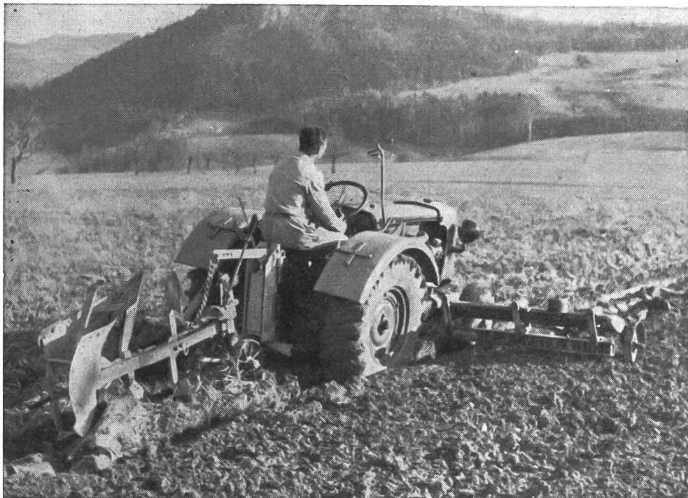
**Ott-Anbaupflüge** mit Stützrädern leisten in der Ebene und am Hang beste Arbeit. Sie sind während der Arbeit weitgehend unabhängig von den Bewegungen des Traktors und in der Arbeitsleistung deshalb den Selbsthalterpflügen am ähnlichsten. Verlangen Sie unverbindliche Offerten für Anbaupflüge und Anbaukultivatoren.
