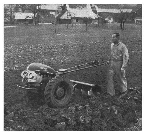
Abb. 7: Einachstraktor KT 10 mit Rotoregge Bucher bei der Arbeit
