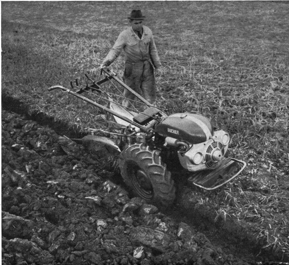
Abb. 6: Einachstraktor Bucher KT 10 beim Pflügen mit Wendepflug Ott
