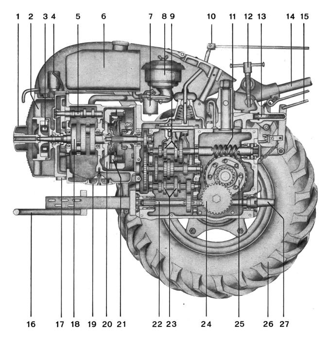
Abb. 2: Längsschnitt durch den Einachstraktor Bucher KT 10
