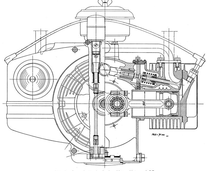
Abb. 4: Querschnitt durch den Motor Universal DB
