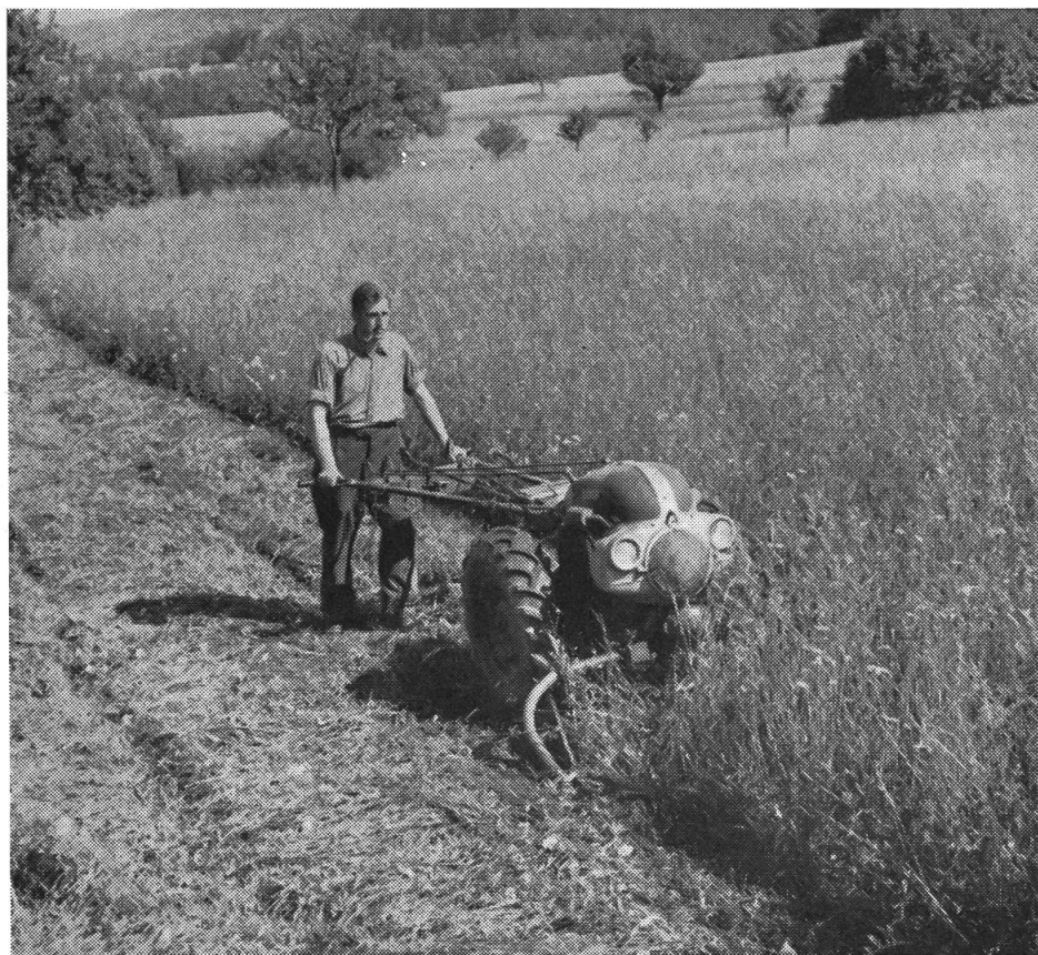
Abb. 5: Einachstraktor Bucher KT 10 beim Mähen
