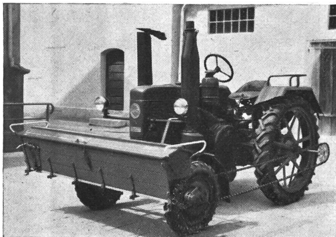
Abb. 3: Düngerstreuer «Rauch» DK 2, frontal am Traktor angebaut.
