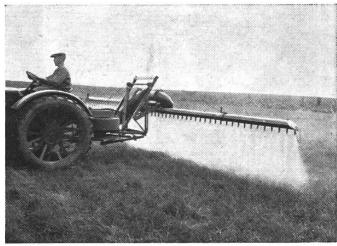
Abb. 9: Anbausprühaggregat «Chiron», für Traktoren.
