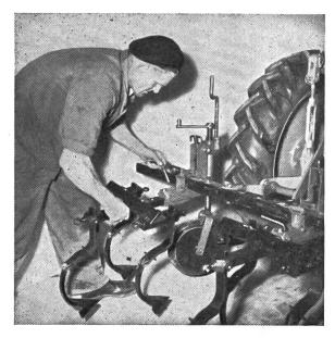
Die Werkzeuge lassen sich leicht und rasch auswechseln: einstecken in den Halter und befestigen mit Stecknagel.
