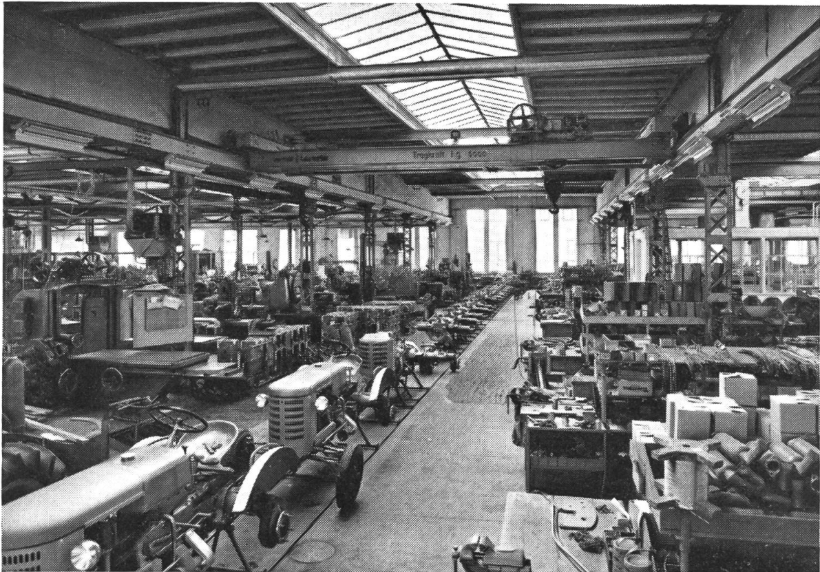
Abb. 3: Bührer-Traktoren Modell «Spezial» auf dem Endmontage-Weg.
