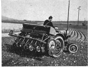
Abb. 1: Vollsattelgerät, zur Kartoffelbearbeitung Stützrolle für Tiefgangsregelung.
