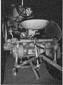
Abb. 3: Kartoffelroder als Sattelgerät am Traktor. Die Aushubhöhe ist so gross, dass der Kartoffelwagen gleichzeitig angehängt werden kann.
